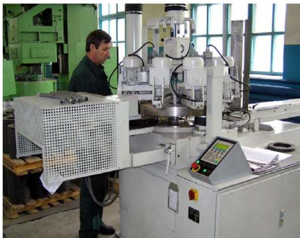
Автоматический станок для сверления накладок фрикционных эллипсовидных
