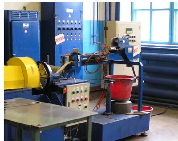
Автоматический станок навивки заготовок накладок фрикционных эллипсовидных
