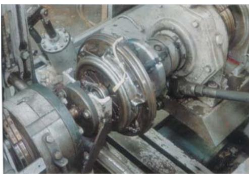
В испытательной лаборатории действуют четыре инерционных и один моторный стенд для испытания натуральных образцов фрикционных и тормозных накладок и уплотнительных материалов и прокладок, что позволяет разрабатывать новые изделия, полностью удовлетворяющие требования потребителей.
